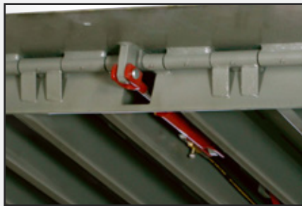
Cilindro flexible de reborde completamente hidráulico.
