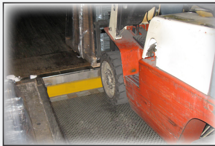
La barrera está diseñada para permitir la carga final en el muelle/andén de carga.
