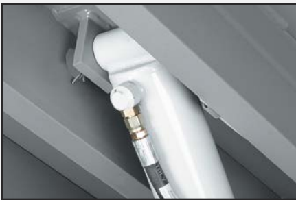
Cilindro de elevación de estilo pión invertido.
