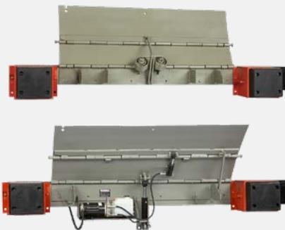
Los niveladores de borde de muelle/andén son una solución ideal para aplicaciones exclusivas. Se montan directamente en la superficie del muelle y proporcionan un margen de trabajo recomendado de +/- 8 cm (3") y un margen de funcionamiento máximo de 13 cm (5") sobre o bajo el nivel del muelle. Las unidades se ofrecen con accionamiento mecánico o hidráulico.
