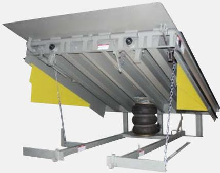
Los niveladores de muelle/andén accionados por aire son una alternativa económica a los niveladores hidráulicos, e igual se accionan con un botón pulsador para facilitar el uso. Tienen una capacidad media y cuentan con un sistema de bolsa de aire o fuelle que se usan para elevar y bajar el muelle. El modelo CentraAir utiliza aire comprimido y no necesita electricidad en el pozo del muelle.
