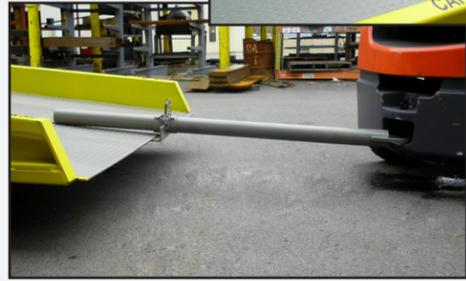
La "abrazadera de remolque" se conecta entre la cavidad de la rampa y el enganche de remolque del montacargas, y permite el transporte fácil de la elevación en grandes distancias.
