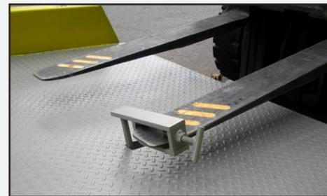
La "abrazadera de horquilla" permite un posicionamiento fácil de la rampa en distancias cortas. La abrazadera de horquilla se inserta en la cavidad de la rampa y se engancha en la paleta del montacargas.
